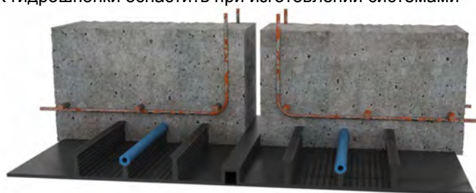
Гидрошпонка AD 50/30/6 с инъекционным шлангом
