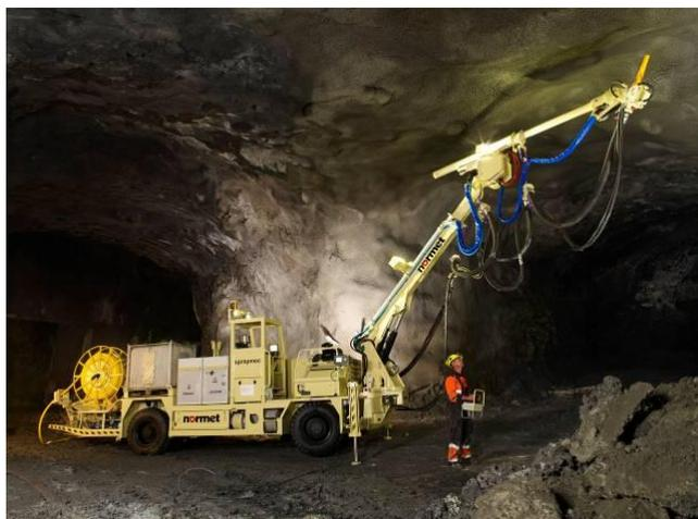
TamShot 90 AF – это жидкий высокоэффективный ускоритель схватывания и набора прочности для технологии набрызгбетонирования.
