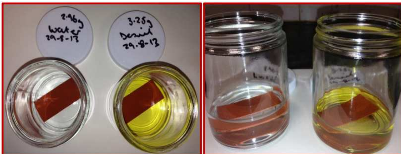
Рисунок 3.2 – Образцы TamSeal 800 в средах (питьевой воде и дизельном топливе)
